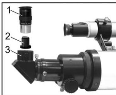
Телескоп имеет большие увеличения и как следствие этого – малые поля зрения. Это затрудняет поиск объектов на небе, поэтому телескоп снабжен оптическим искателем с большим полем зрения. С помощью искателя можно быстро находить необходимый объект на небе и затем наблюдать его в поле зрения телескопа.
